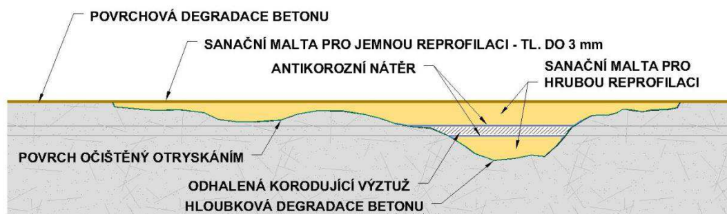
Obr. 24 Schéma hloubkové reprofilace poškozených míst
